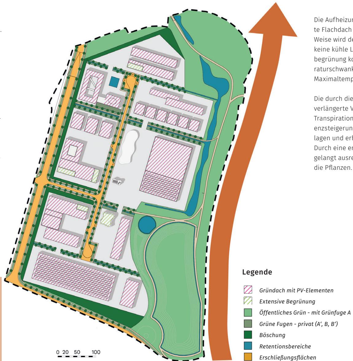
Die Aufheizung der Luft soll durch das begrünte Flachdach abgemildert werden. Auf diese Weise wird dem Gebiet und seiner Umgebung keine kühle Luft entzogen. Durch die Dachbegrünung kommt es zu geringeren Temperaturschwankungen und einer niedrigeren Maximaltemperatur auf der Dachfläche.
